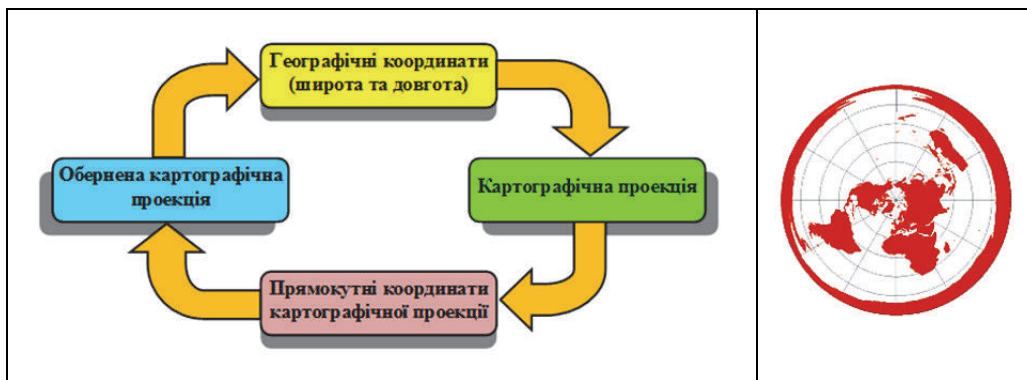
Рис.К.4 – Загальна схема перетворення координат (за [73]) і приклад застосування азимутальної рівнопроміжної картографічної проекції (емблема ООН) (за [74]) ([76])
