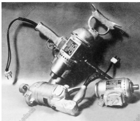
Зразки продукції електроінструментального заводу комуни: електросвердлувальні машини ФД-1 (ліворуч) та ФД-3 (вгорі), електрошліфувальна машина ФД-2 (праворуч) (На крильях історії. 75 лет заводу "ФЭД" / ред. кол.: А. Ф. Боринос и др. – Х. : Майдан, 2002.)
