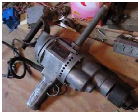
Оригінальний діючий екземпляр електричного дреля компанії “Black & Decker”, що послужив прототипом електросвердлувальної машини ФД-3 ( https://www.youtube.com/watch?v=Usb6gsgT5Kc )
