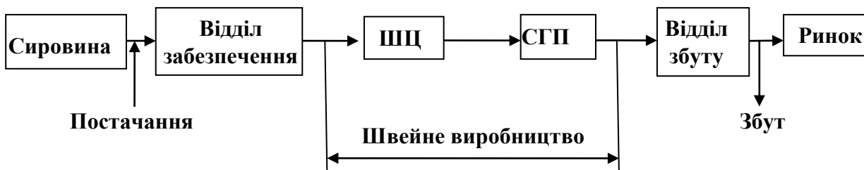
Рис. 3.2. Структурна схема малого підприємства із незакінченим технологічним циклом: ШЦ – швейний цех, СГП – склад готової продукції
