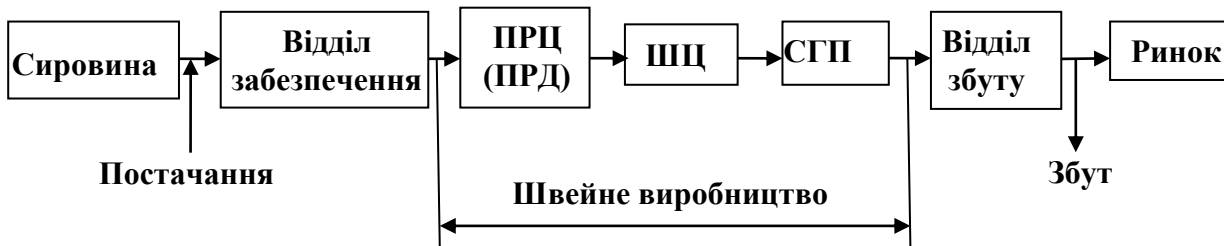
Рис. 3.1. Структурна схема малого підприємства із закінченим технологічним циклом: ПРЦ (ПРД) – підготовчо-розкрійний цех (ділянка), ШЦ – швейний цех, СГП – склад готової продукції
