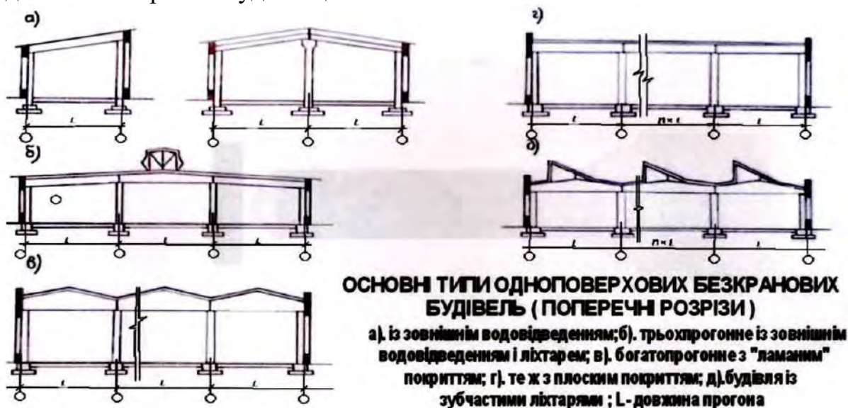
Рис. 9.1. Основні типи одноповерхових безкранових будівель
