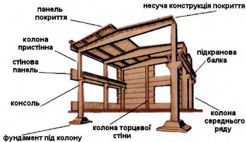
Рис. 9.4. Будівля з повним каркасом
