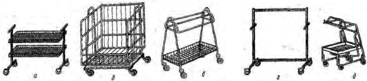
Рис. 4.18. Безпривідні нестационарні внутрішньопроектні транспортні засоби: а – візок-стелаж; б – візок-контейнер; в – візок з піддоном; з – візок-кронштейн, д – візок-затискач
