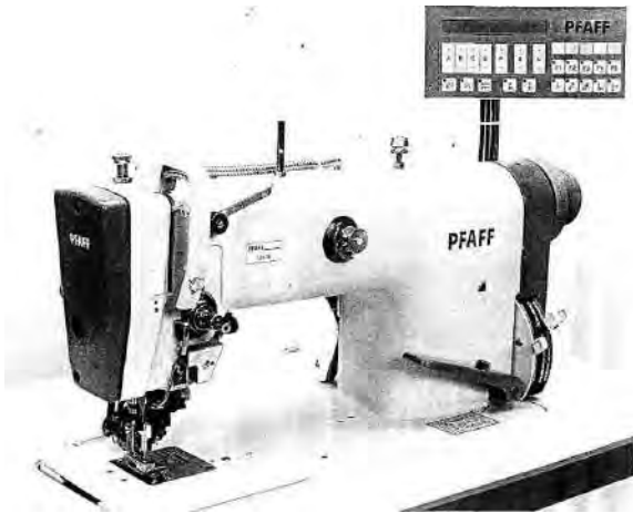
Рис. 2.1. Універсальна машина PFAFF 487-G 918/14 BS×5.0
