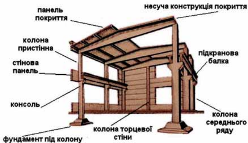
Рис. 9.4. Будівля з повним каркасом
