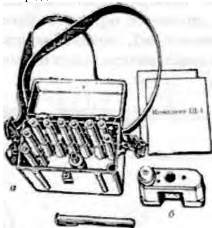
Рис. 3.1. Комплект індивідуальних дозиметрів ІД-1: а – загальний вигляд комплекту; б – зарядний пристрій ЗД-6; в – дозиметр
