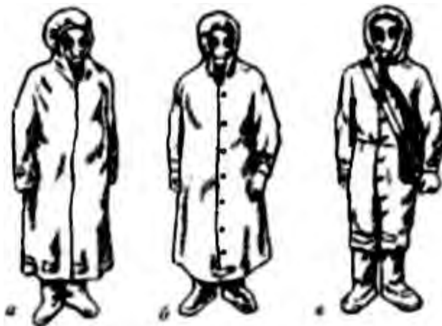
Рис. 4.8. Загальновійськовий захисний комплект (ЗЗК) а – у вигляді накидки; б – одягнений у рукави; в – у вигляді комбінезона
