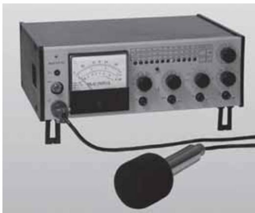
Рисунок 8. Прилад для вимірювання шуму та вібрації ВШВ-1
