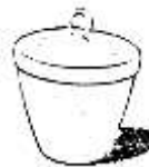
Тигель порцеляновий для нагрівання та прожарювання твердих речовин
