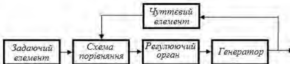
Рис. 1.36. Структурна схема регулятора напруги
