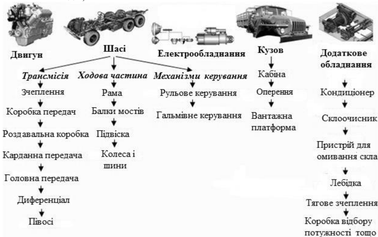
Рис. 1.2. Загальна будова вантажного автомобіля
