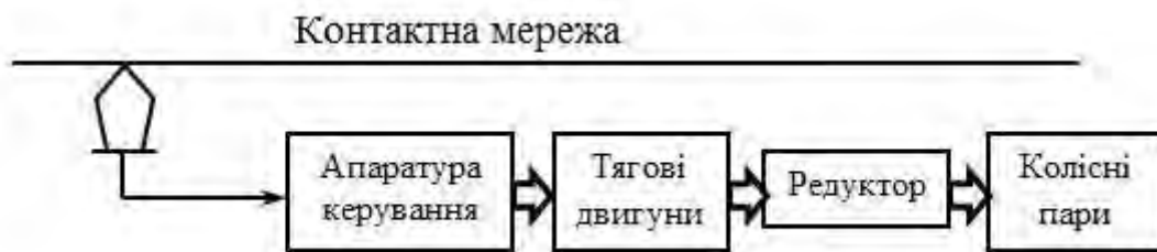
Рис.5.5. Структурна схема передачі потужності у електровозі
