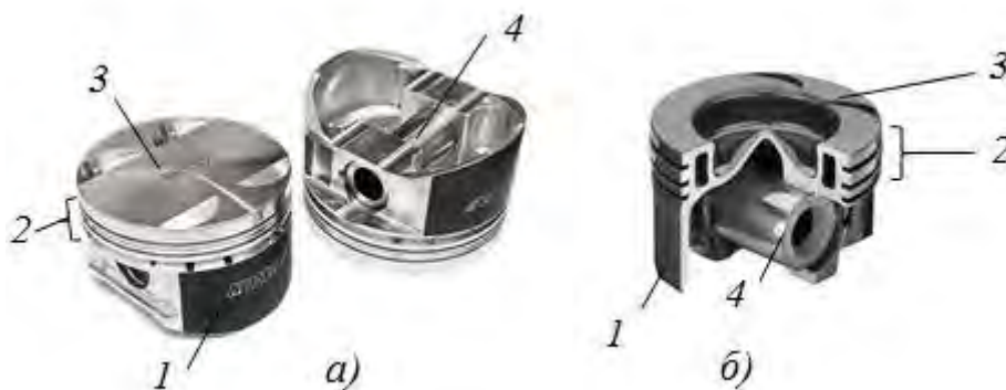
Рис. 1.9. Поршні бензинового (а) та дизельного (б) двигунів: 1 – юбка поршня; 2 – головка поршня; 3 – днище поршня; 4 – поршневий палець
