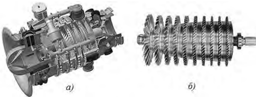
Рис. 3.39. Загальний вигляд осьового компресора( a ) та його ротора ( б )
