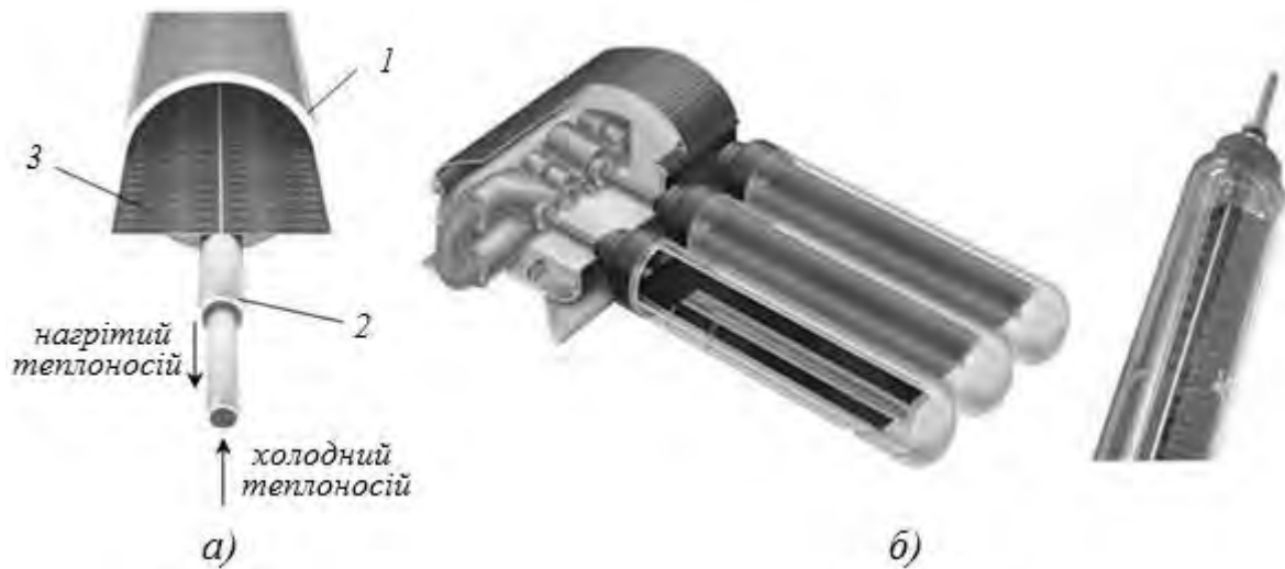
Рис. 3.82. Вакуумні трубки з прямоточним каналом: схема будови (а), загальний вигляд (б):
