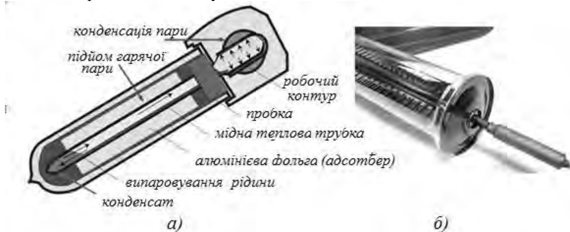
Рис. 3.81. Схема вакуумної трубки «Heat pipe»(а) та її загальний вигляд(б)
